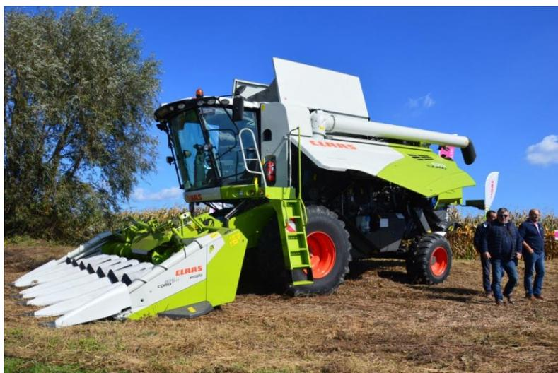
Рис. 19 – Комбайн зерноуборочный Claas с початкоотделителем Conspeed, ширина захвата 9 м, АО «Березовское» Курагинского района, 2020 г.
